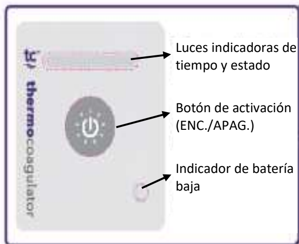
Figura 3: Botón de activación y luces indicadoras
