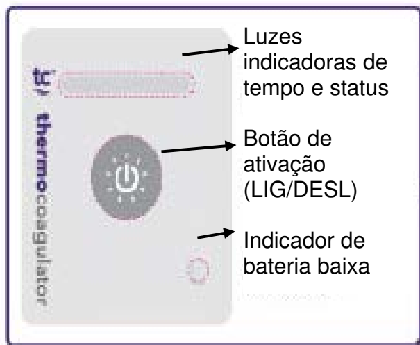
Figura 3: botão de ativação e luzes indicadoras
